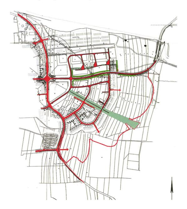
Die Zufahrtstraße zum Papenberg *Zum Pfennigsberg* wird anbaufrei vom ausgebauten Abschnitt südlich der Eisenbahnüberführung bis *Zu den Kirchentannen* geführt. Sie erhält einen aktiven Schallschutz in Form von Lärmschutzwällen mit Lärmschutzwänden und Lärmschutzwänden im bebauten Bereich. Hierdurch teilt sich das Gebiet in 2 Bereiche.
