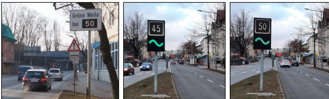
Abb. 28 Beispiele dynamische Hinweistafeln zur LSA-Koordinierung („Grünen Welle“)
