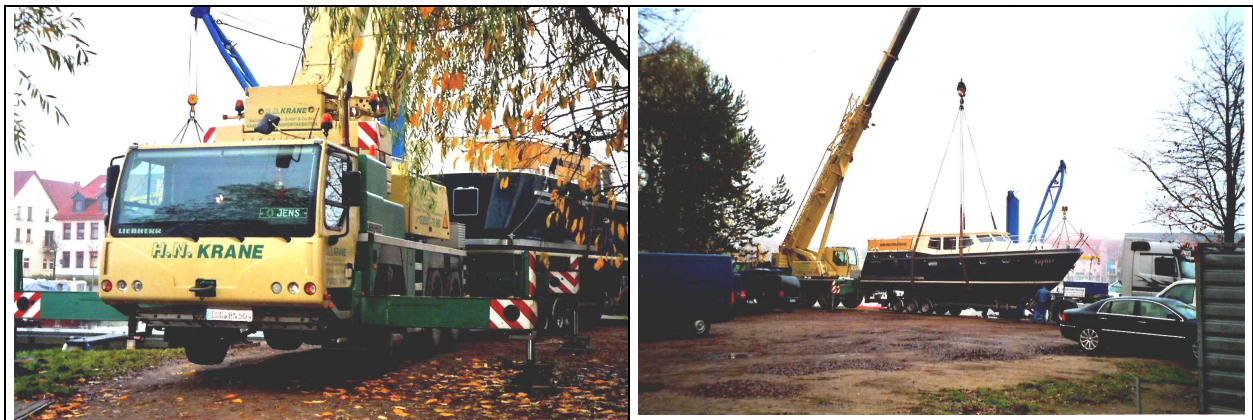
Bekranungsvorgang mit mobilem Autodrehkran (100 t) am Südkai des Stadthafens (Fotos: plan4)
